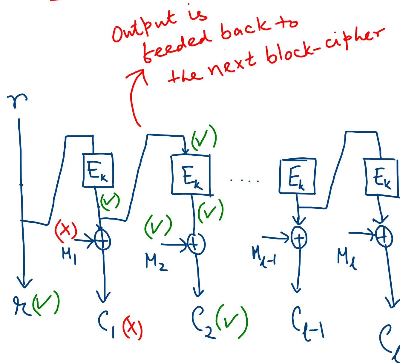
$\text{Deck}_K(C_0 || C_1 || \dots || C_t)$
